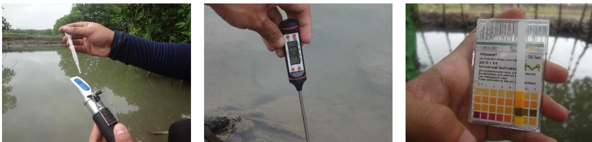
**Gambar 2.** Pengukuran Parameter Lingkungan; salinitas (kiri), suhu (tengah) dan pH (kanan)
